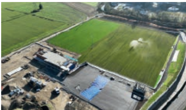
Übersichtsfoto-02 ➔ nach Verlegung der Rasensoden / Fertiggras auf den Spielfeldern und Nebenflächen, inkl. aktivierter Beregnung sowie Einzäunung der Sportanlage
